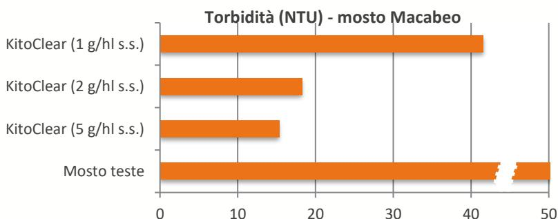
*Diminuzione della torbidità in mosto Macabeo torchiato e fottato con diverse dosi di KitoClear. Il mosto teste aveva una torbidità di 1000 NTU.*
