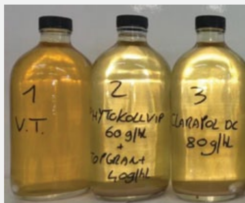
Imbrunimento del colore in vino test e in vino chiarificato. Test di ossidabilità con H_2O_2
